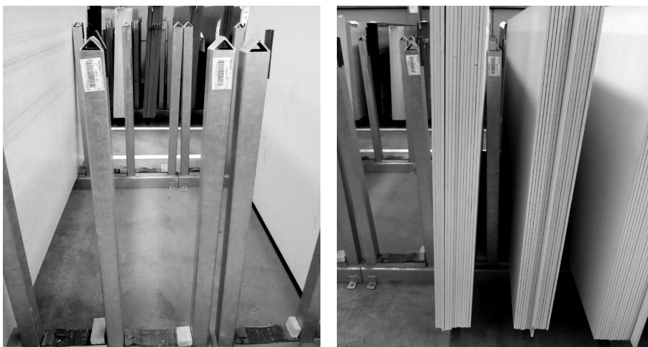
опоры для хранения слэбов
